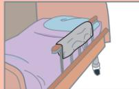
サイドレール/介助バーにパッドを配置し、利用者がパッドを握るとナースコールします。送信機はセンサーに内蔵出来るので、邪魔なコードが出ません。見張り番II (08-09) の送受信機を使用してナースコールと接続します。
