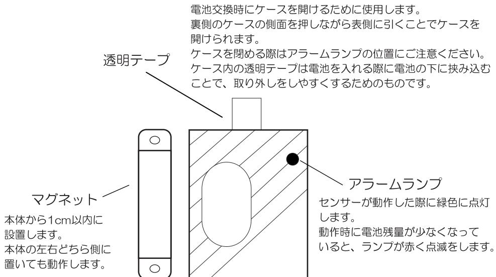
ドアが開いて本体とマグネットが離れることでセンサーが動作し、アラーム信号を発報します。
